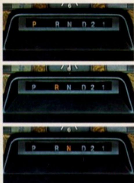
Optische Anzeige für die gewählte Fahrstufe beim Automatikgetriebe
