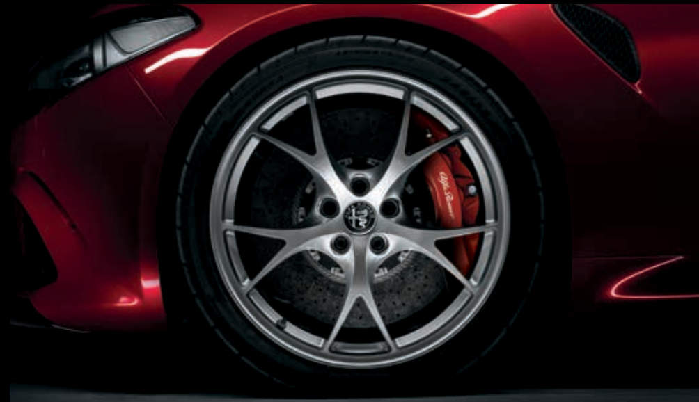
19"-Leichtmetallfelgen TROFEO. Vorne: 8,5J x 19 mit Bereifung 245/35 ZR19 Hinten: 10J x 19 mit Bereifung 285/30 R19
