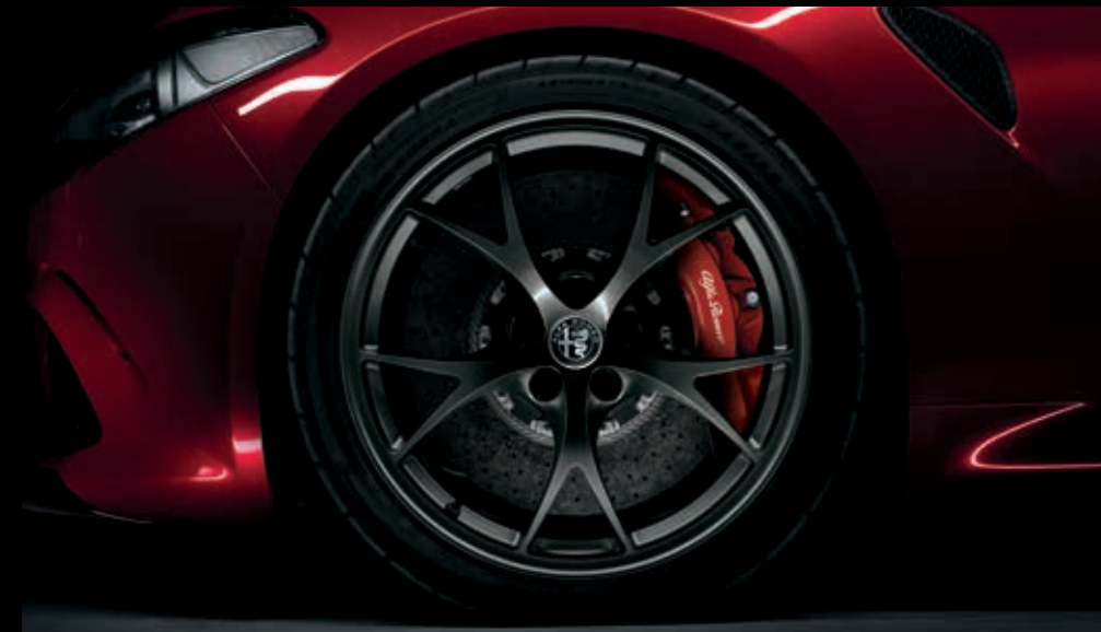
19"-Leichtmetallfelgen TROFEO, dunkel lackiert. Vorne: 8,5J x 19 mit Bereifung 245/35 ZR19 Hinten: 10J x 19 mit Bereifung 285/30 R19
