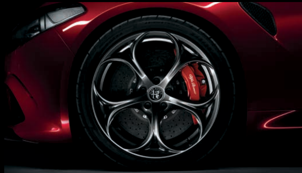
19"-Leichtmetallfelgen CLASSICO, dunkel lackiert. Vorne: 8,5J x 19 mit Bereifung 245/35 ZR19 Hinten: 10J x 19 mit Bereifung 285/30 R19
