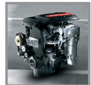
1.4 TB 16V MultiAir-Motor mit 125 kW (170 PS)
