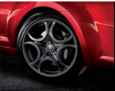
○ 5FB - Leichtmetallfelgen 7J x 17" Sport I in „Dark Chrome“ lackiert mit Bereifung 215/45 R17
