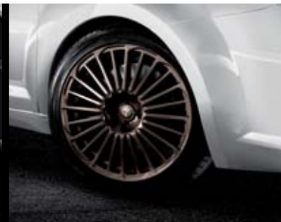
○ 7HP - Leichtmetallfelgen 7J x 17" Elegante I in Bronze lackiert* mit Bereifung 215/45 R17
