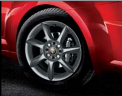
○ 5A6 - Leichtmetallfelgen 6J x 15" Impression mit Bereifung 185/65 R15
