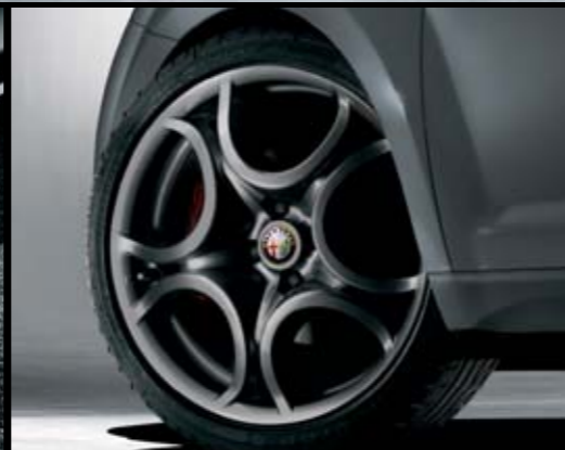
Leichtmetallfelgen 7J x 17" Sport 1 in „Dark Chrome“ lackiert mit Bereifung 215/45 R17
