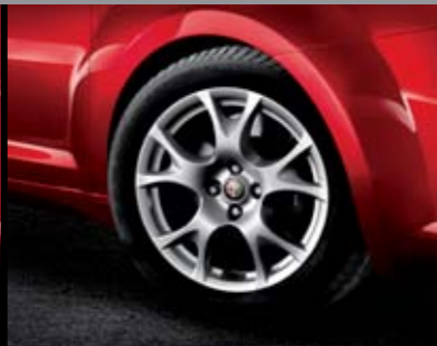
○ 108/421 - Leichtmetallfelgen 7J x 16" Sport mit Bereifung 195/55 R16
