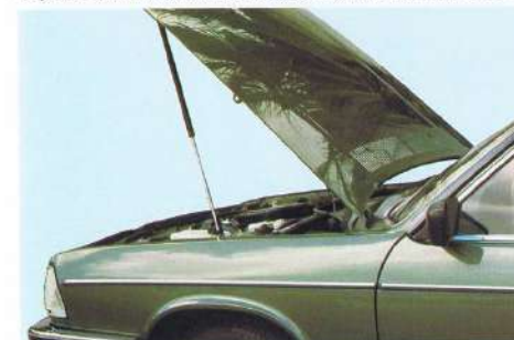
Motorhaubenfeststellung mit Gasdruckfeder (GL).
