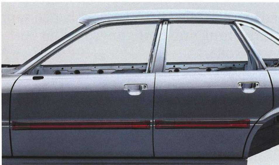
Die Flankenschutzträger sind fest mit den Seitentüren verbunden.
