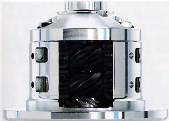
Das Torsen-Zwischendifferential regelt die Kraftverteilung automatisch und variabel.
