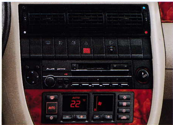
Die Bedienungselemente für Heizung und Belüftung.
