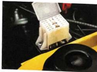
Der Diagnose-Stecker verbindet den Audi 80 mit dem AUDI NSU-Computer-Diagnose-System.
