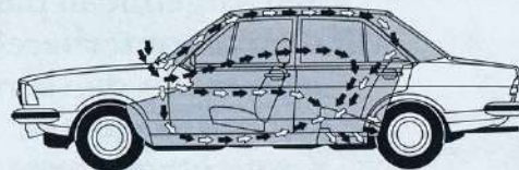
Das schnellwirkende Heizungs- und Belüftungssystem des Audi 80. Vollständiger Luftaustausch in 20 Sekunden.
