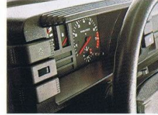
Armaturentafel mit Blendschutz
