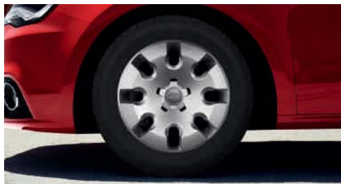
■ Winter-Stahlräder mit Radvollblende, Größe 6 J x 15 mit Reifen 185/60 R 15 (schneekettentauglich)
