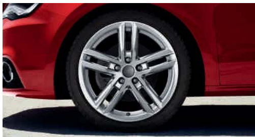
■ Aluminium-Gussräder Audi exclusive im 5-Doppelspeichen-Design, Größe 7,5 J x 17 mit Reifen 215/40 R 17. Ein Angebot der quattro GmbH
