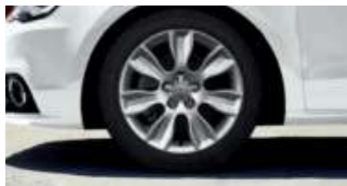
Winter-Aluminium-Gussräder im 7-Arm-Dynamik-Design Größe 6 J x 16 mit Reifen 195/50 R 16* (wahlweise mit Reifen mit Notlaufeigenschaften, schneekettentauglich)
