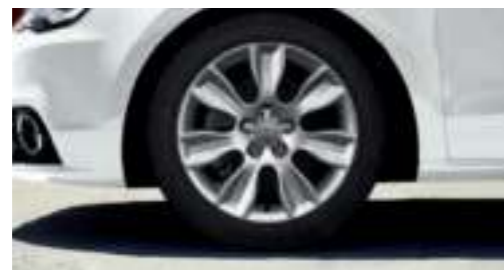
Aluminium-Gussräder im 7-Arm-Dynamik-Design Größe 7 J x 16 mit Reifen 215/45 R 16* (wahlweise mit Reifen mit Notlaufeigenschaften)
