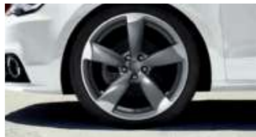
Aluminium-Gussräder Audi exclusive im 5-Arm-Rotor-Design in Titanoptik matt glanzgedreht, Größe 7,5 J x 18 mit Reifen 225/35 R 18*. Ein Angebot der quattro GmbH
