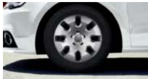
Stahlräder mit Radvollblende Größe 6 J x 15 mit Reifen 185/60 R 15* (exklusiv bei 1.2 TFSI Attraction); Größe 6,5 J x 15 mit Reifen 205/55 R 15*
