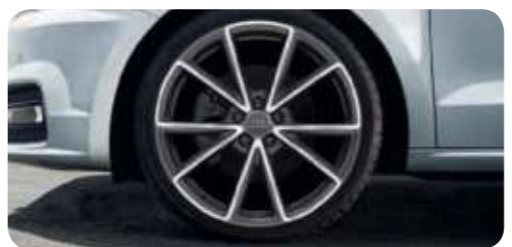
Aluminium-Gussräder Audi Sport im 5-V-Speichen-Design in Titanoptik matt, glanzgedreht 2 Größe 7,5 J x 18 mit Reifen 225/35 R 18 1 . Ein Angebot der quattro GmbH
