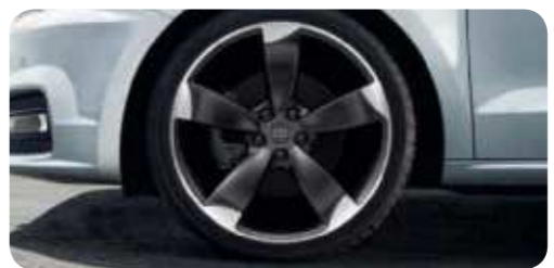
Aluminium-Gussräder Audi Sport im 5-Arm-Rotor-Design in Schwarz matt, glanzgedreht 2 Größe 7,5 J x 18 mit Reifen 225/35 R 18 1 . Ein Angebot der quattro GmbH
