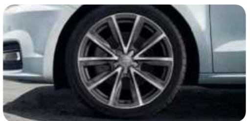
Aluminium-Gussräder im 5-Speichen-V-Design, kontrastgrau, teilpoliert 2 Größe 7,5 J x 17 mit Reifen 215/40 R 17 1
