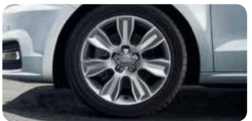
Winter-Aluminium-Gussräder im 5-Arm-Dynamik-Design Größe 6 J x 16 mit Reifen 195/50 R 16 1 , zulässige Höchstgeschwindigkeit 210 km/h, schneekettentauglich
