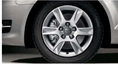
Winter-Aluminium-Gussräder im 6-Speichen-Design, Größe 6,5 J x 16 mit Reifen 205/55 R 16, nicht schneekettentauglich, zulässige Höchstgeschwindig- keit 210 km/h
