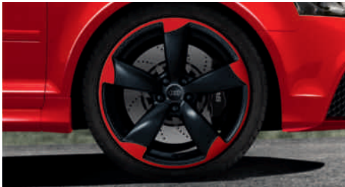
■ Aluminium-Gussräder im 5-Arm-Rotor-Design in Schwarz mit Felgenhorn in Rot, Größe 8 J x 19 mit Reifen 235/35 R 19 vorn und 225/35 R 19 hinten
