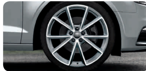
Aluminium-Gussräder Audi exclusive im 5-V-Speichen-Design in Titanoptik matt, glanzgedreht 2,3 Größe 8 J x 19 mit Reifen 235/35 R 19 1 . Ein Angebot der quattro GmbH
