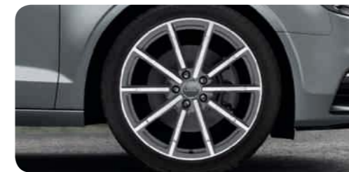
Aluminium-Gussräder Audi Sport im 10-Speichen-Design in Titanoptik matt, glanzgedreht 2 Größe 8 J x 18 mit Reifen 225/40 R 18 1 . Ein Angebot der quattro GmbH
