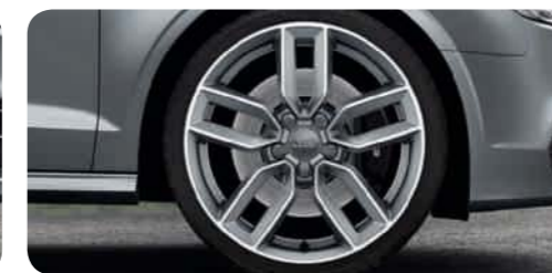
Aluminium-Gussräder im 5-Doppelspeichen-Stern-Design (S-Design) 3 kontrastgrau, teilpoliert 2 , Größe 8 J x 19 mit Reifen 235/35 R 19 1 . Nur für S3 Limousine/S3 Cabriolet erhältlich
