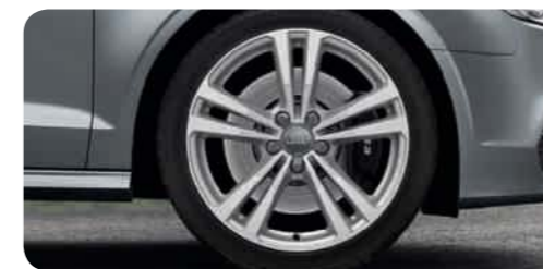
Aluminium-Gussräder im 5-Parallelspeichen-Design (S-Design) teilpoliert 2 , Größe 8 J x 18 mit Reifen 225/40 R 18 1 . Nur für S3 Limousine/S3 Cabriolet bzw. in Verbindung mit S line Sportpaket erhältlich
