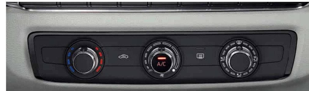
Klimaanlage manuell kühlt bzw. erwärmt den Fahrzeuginnenraum; manuell einstellbare Luftverteilung, manueller Umluftbetrieb, stufenloses Gebläse und Partikelfilter; 4 runde, separat punktförmig oder gleichmäßig einstellbare Ausströmer in der Armaturentafel, Fußraumausströmer vorn und hinten sowie Defrosterdüsen für Front- und Seitenscheiben
