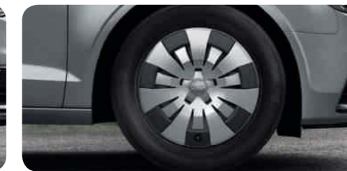
Winter-Stahlräder inklusive Radvollblende 4 Größe 6,5 J x 16 mit Reifen 205/55 R 16 1 , zulässige Höchstgeschwindigkeit 210 km/h, schneekettentauglich
