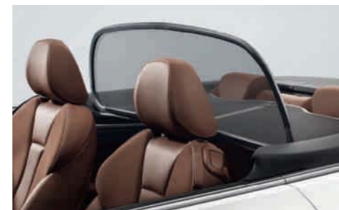
Windschott reduziert die Windströmungen im Innenraum; einfaches Bedienkonzept sowie leichte Anbringung
