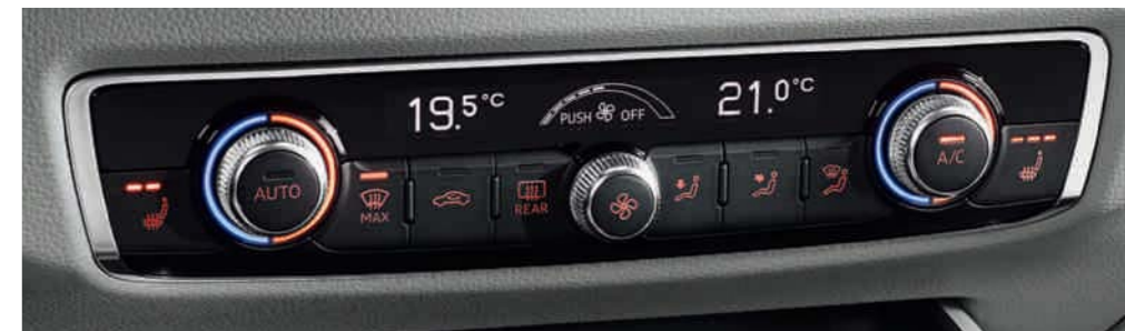
Komfortklimaautomatik jeweils getrennte Temperaturregelung von Fahrer und Beifahrer mit indirekter Belüftung über Defrosterdüsen und sonnenstandsabhängiger Regelung; regelt elektronisch die Lufttemperatur, -menge und -verteilung; automatische Umluftregelung durch Luftgütesensor, Kombifilter und Fondausströmer. Mit Feuchtesensor und Schlüsselkennung
