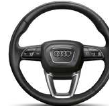
Abbildung zeigt spezifisches Lenkraddesign mit Grifferkennung in Verbindung mit dem adaptiven Fahrassistenten
