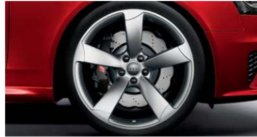
Aluminium-Gussräder im 5-Arm-Rotor-Design Größe 9 J x 20 mit Reifen 265/30 R 20*
