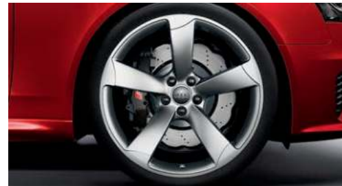
Winter-Aluminium-Gussräder im 5-Arm-Rotor-Design Größe 9 J x 20 mit Winterreifen 265/30 R 20*, nicht schneekettentauglich, zulässige Höchstgeschwindigkeit 240 km/h
