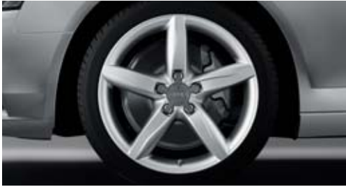
Winter-Aluminium-Gussräder im 5-Speichen-Stern-Design Größe 8 J x 18 mit Reifen 245/40 R 18, Höchstgeschwindigkeit 240 km/h, nicht schneekettentauglich
