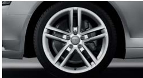
Aluminium-Gussräder Audi exclusive im 5-Doppelspeichen-Design Größe 8 J x 18 mit Reifen 245/40 R 18. Ein Angebot der quattro GmbH
