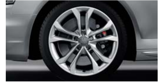
Aluminium-Gussräder im 5-Parallelspeichen-Design (S-Design) Größe 8 J x 18 mit Reifen 245/40 R 18
