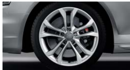
Winter-Aluminium-Gussräder im 5-Parallelspeichen-Design (S-Design) Größe 8 J x 18 mit Reifen 245/40 R 18*, nicht schneekettentauglich, Höchstgeschwindigkeit 240 km/h
