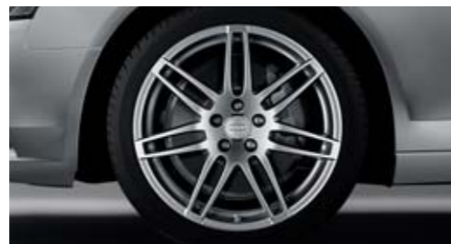
Aluminium-Gussräder Audi exclusive im 7-Doppelspeichen-Design Größe 8,5 J x 19 mit Reifen 255/35 R 19*. Ein Angebot der quattro GmbH
