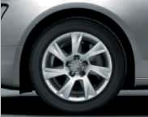
Aluminium-Gussräder im 7-Arm-Design, Größe 7,5 J x 17 mit Reifen 225/50 R 17
