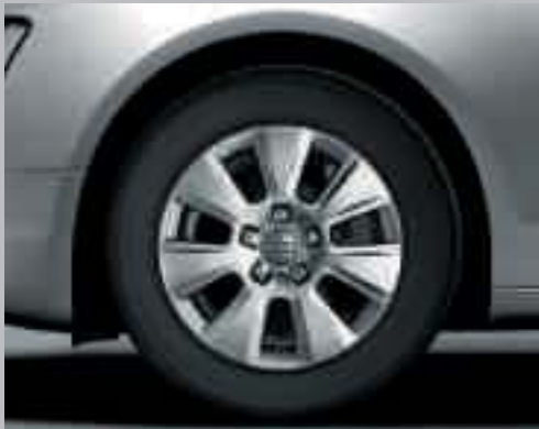
Aluminium-Gussräder im 7-Arm-Parabel-Design, Größe 7,5 J x 17 mit Reifen 225/50 R 17
