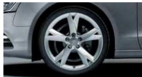
Aluminium-Gussräder im 5-Arm-Y-Design Größe 8,5 J x 19 mit Reifen 255/35 R 19
