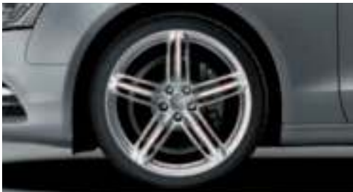
Aluminium-Gussräder Audi exclusive im 5-Segmentspeichen-Design Größe 9 J x 19 mit Reifen 255/35 R 19. Ein Angebot der quattro GmbH
