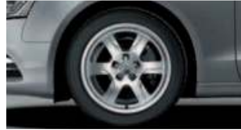
Winter-Aluminium-Schmiederäder im 6-Arm-Design Größe 7,5 J x 17 mit Reifen 225/50 R 17, zulässige Höchstgeschwindigkeit 210 km/h, schneekettentauglich
