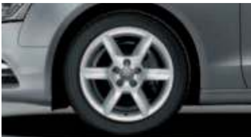
Aluminium-Gussräder im 6-Speichen-Parabol-Design Größe 8 J x 17 mit Reifen 245/45 R 17
