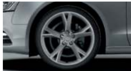
Leichtbauäder in Aluminium-Verbundbauweise im 5-Arm-Y-Design in Galvanograu Metallic, matt Größe 8,5 J x 19 mit Reifen 255/35 R 19*
