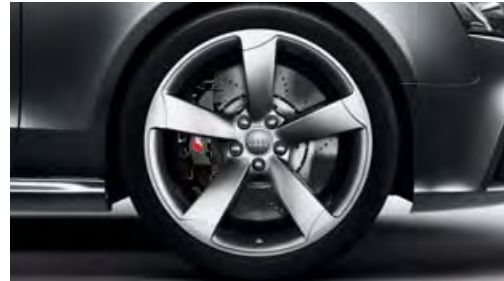
Winter-Aluminium-Gussräder im 5-Arm-Rotor-Design, Größe 9 J x 20 mit Reifen 275/30 R 20, nicht schneekettentauglich, zulässige Höchst- geschwindigkeit 270 km/h
