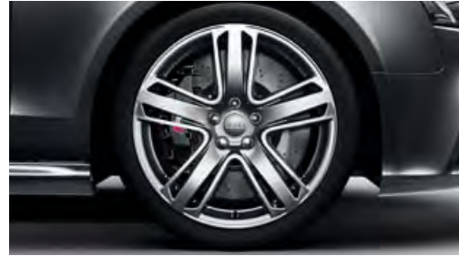
Winter-Aluminium-Gussräder im 5-Arm-Struktur-Design, Größe 8 J x 19 mit Reifen 235/40 R 19, schneeketten- tauglich, zulässige Höchstgeschwindigkeit 240 km/h
