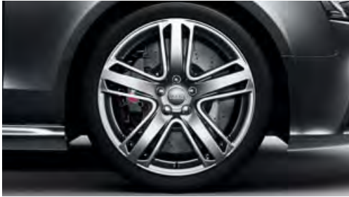
Aluminium-Gussräder im 5-Arm-Struktur-Design, Größe 9 J x 19 mit Reifen 265/35 R 19
