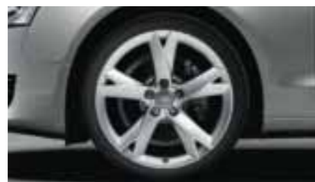
Aluminium-Gussräder im 5-Arm-Y-Design, Größe 8,5 J x 19 mit Reifen 255/35 R 19
