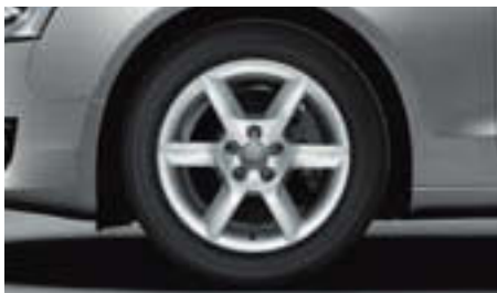
Aluminium-Gussräder im 6-Speichen-Parabol-Design 1 , Größe 8 J x 17 mit Reifen 245/45 R 17
