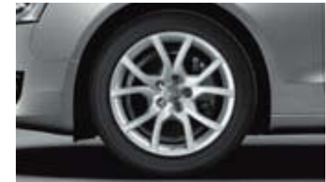
Winter-Aluminium-Gussräder im 10-Speichen- V-Design, Größe 8,5 J x 18 mit Reifen 245/40 R 18, zulässige Höchstgeschwindigkeit 240 km/h, nicht schneekettentauglich
