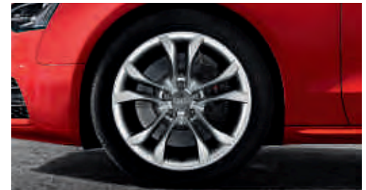
Winter-Aluminium-Gussräder im 5-Parallelspeichen-Design (S-Design) Größe 8 J x 18 mit Reifen 245/40 R 18, zulässige Höchstgeschwindigkeit 240 km/h, schneekettentauglich
