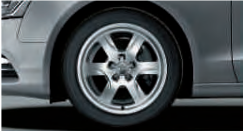
Winter-Aluminium-Schmiederäder im 6-Arm-Design Größe 7,5 J x 17 mit Reifen 225/50 R 17, zulässige Höchstgeschwindigkeit 210 km/h, schneekettentauglich (wahlweise mit Reifen mit Notlaufeigenschaften)
