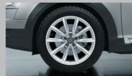
Aluminium-Gussräder im 10-Speichen-Design, Größe 8 J x 18 mit Reifen 245/45 R 18. (Serie bei 4.2 FSI)
