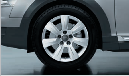
Aluminium-Gussräder im 7-Arm-Rotor-Design, Größe 8 J x 17 mit Reifen 225/55 R 17
