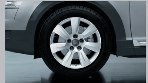
Winter-Aluminium-Gussräder im 7-Arm-Rotor-Design, Größe 7 J x 17 mit Reifen 215/55 R 17, zulässige Höchstgeschwindigkeit 210 km/h, schneekettentauglich
