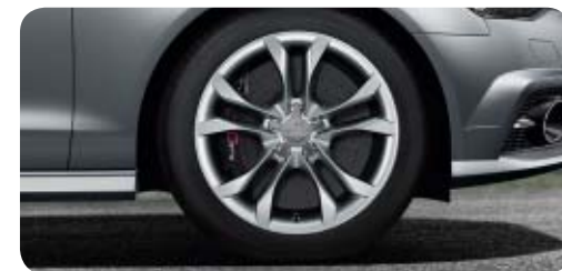
Aluminium-Gussräder im 5-Parallelspeichen-Design (S-Design) Größe 8,5 J x 19 mit Reifen 255/40 R 19 1 . Nur für S6 Limousine und S6 Avant erhältlich
