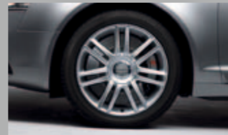
Winter-Aluminium-Gussräder im S Design, Größe 8,5 J x 18 mit Reifen 255/40 R 18, nicht schneekettentauglich, zulässige Höchstgeschwindigkeit 240 km/h
