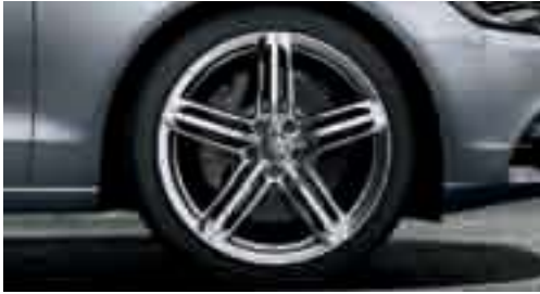
■ Aluminium-Gussräder Audi exclusive im 5-Segmentspeichen-Design, Größe 8,5 J x 20 mit Reifen 255/35 R 20. Ein Angebot der quattro GmbH
