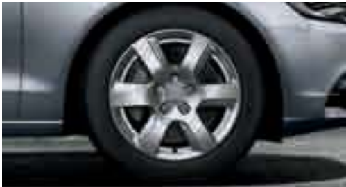
■ Aluminium-Schmiederäder im 6-Arm-Design, Größe 8 J x 17 mit Reifen 225/55 R 17
