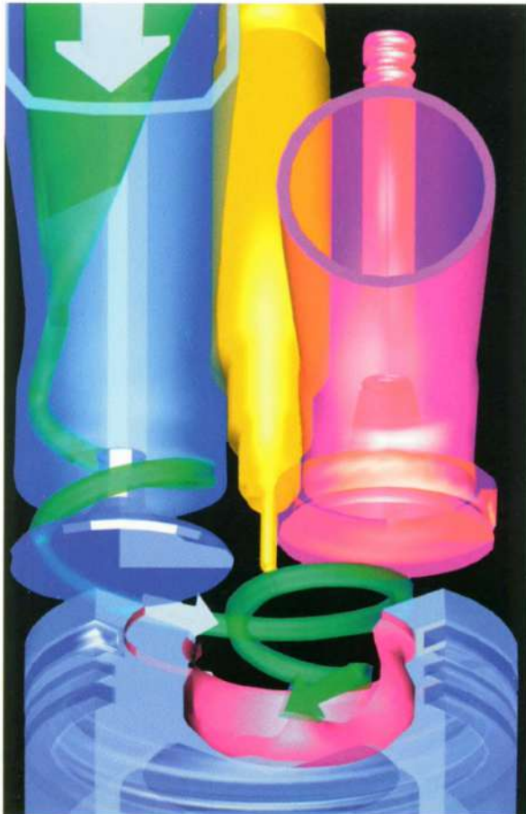
Turbodiesel-Direkteinspritzung: Konstruktive Feinarbeit wie die Gestaltung des Ansaugrohrs als Drallkanal und die Kolbenmulde sorgen für eine optimale Gemischbildung
