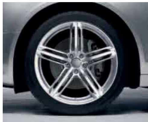
Aluminium-Gussräder Audi exclusive im 5-Segmentspeichen-Design, Größe 8,5 J x 19 mit Reifen 255/35 R 19. Ein Angebot der quattro GmbH
