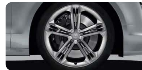
Aluminium-Gussräder im 5-Triplespeichen-Design (S-Design) Größe 9 J x 21 mit Reifen 265/35 R 21 1 . Nur für S8 erhältlich
