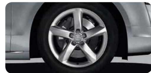
Aluminium-Gussräder im 5-Arm-Design Größe 9 J x 19 mit Reifen 255/45 R 19 1 (wahlweise mit Reifen mit Notlaufeigenschaften)
