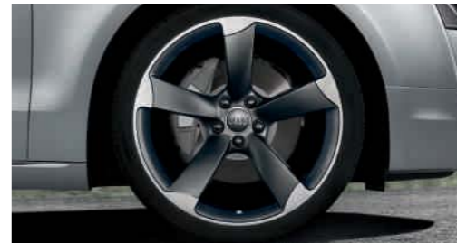
Aluminium-Gussräder Audi exclusive im 5-Arm-Rotor-Design, Titanoptik, glanzgedreht, Größe 9 J x 21 mit Reifen 275/35 R 21
