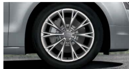
Aluminium-Gussräder im 10-Speichen-Y-Design, teilpoliert, Größe 9 J x 19 mit Reifen 255/45 R 19
