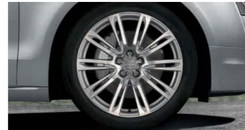
Aluminium-Schmiederäder im 10-Parallelspeichen-Design, teilpoliert, Größe 9 J x 20 mit Reifen 265/40 R 20
