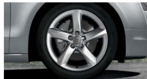
Aluminium-Gussräder im 5-Arm-Design, Größe 9 J x 19 mit Reifen 255/45 R 19
