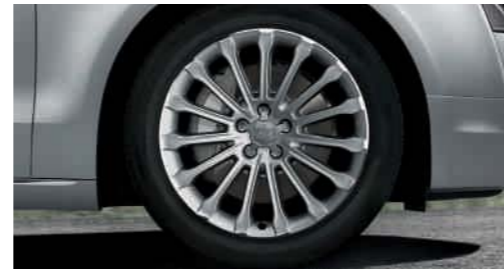
Aluminium-Gussräder im 15-Speichen-Design, teilpoliert, Größe 9 J x 19 mit Reifen 255/45 R 19
