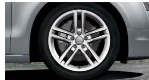
Aluminium-Gussräder Audi exclusive im 5-Doppelspeichen-Design, Größe 9 J x 19 mit Reifen 255/45 R 19
