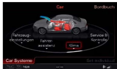
Car: Diese Funktion ermöglicht Ihnen das direkte Ansteuern von Fahrerassistenzsystemen, Fahrzeugeinstellung, Klima, Standheizung und Service.
