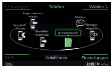
Telefon: Die auf Wunsch erhältliche Handyvorbereitung (Bluetooth) bzw. das Bluetooth-Autotelefon online verfügt über einen Auswahlbildschirm mit Anruflisten, Adressbuch und Wahloberfläche als Starteinstellung.
