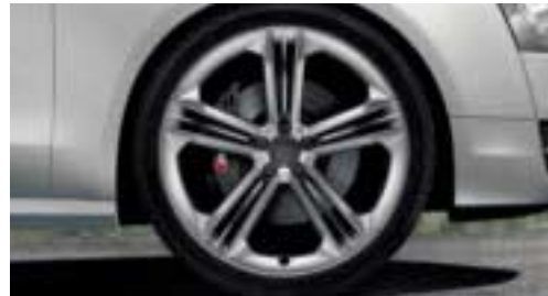
Aluminium-Gussräder im 5-Tripelspeichen-Design (S-Design) Größe 9 J x 21 mit Reifen 265/35 R 21
