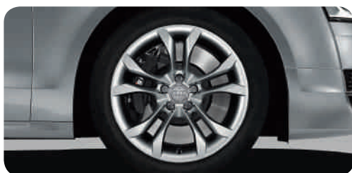
Winter-Aluminium-Gussräder im 5-Parallelspeichen-Design (S-Design) Größe 9 J x 20 mit Reifen 265/40 R 20*, nicht schneekettentauglich, zulässige Höchstgeschwindigkeit 240 km/h
