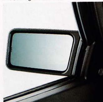
Von innen einstellbarer Fahreraußenspiegel.
