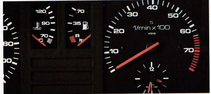
Drehzahlmesser mit integrierter Analog-Zeituhr.
