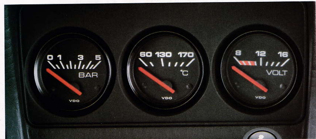
Öltemperatur-, Öldruckanzeige und Voltmeter in Mittelkonsole (GT).
