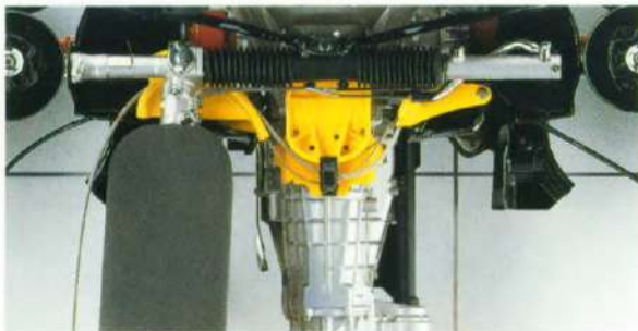
Die Umlenkung für die Stahlseile des procon-ten-Systems.
