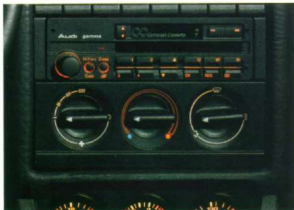
Die Bedienungselemente für Heizung und Belüftung.
