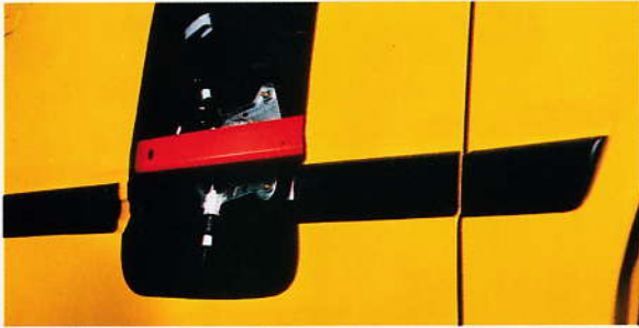
Durch hochfeste Strangpreßprofile in den Türen kann in bestimmten Unfallsituationen die Türverformung erheblich reduziert werden.
