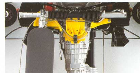
Die Umlenkung für die Stahlseile des procon-ten-Systems.
