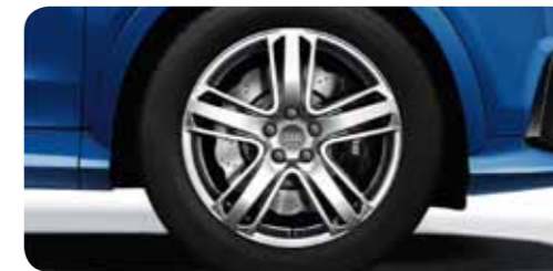
Winter-Aluminium-Gussräder im 5-Arm-Struktur-Design Größe 8 J x 18 mit Winterreifen 225/50 R 18 1 , schneekettentauglich, zulässige Höchst- geschwindigkeit 210 km/h
