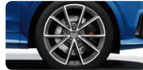
Aluminium-Gussräder im 5-V-Speichen-Design in Titanoptik matt, glanzgedreht 2 Größe 8,5 J x 20 mit Reifen 255/35 R 20 1
