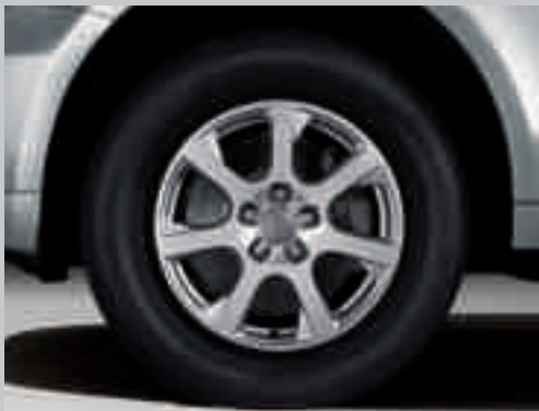
Aluminium-Schmiedeleichtbau­räder im 7-Speichen-Design, Größe 8 J x 17 mit Reifen 235/65 R 17
