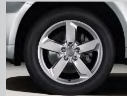
Aluminium-Gussräder im 5-Arm-Design, poliert, Größe 8 J x 19 mit Reifen 235/55 R 19
