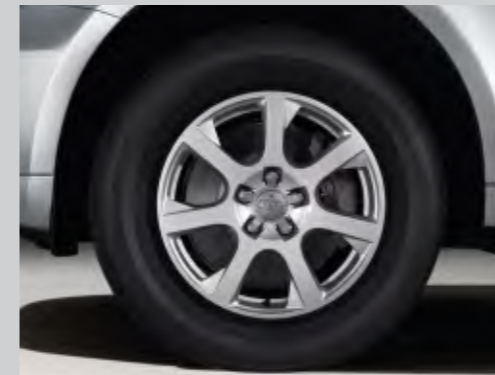
Aluminium-Schmiedeleichtbauräder im 7-Speichen-Design, Größe 8 J x 17 mit Reifen 235/65 R 17
