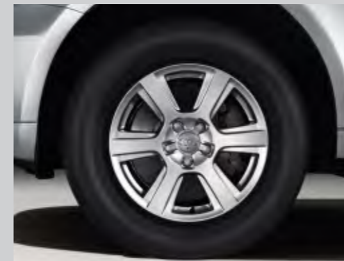
Aluminium-Gussräder im 6-Arm-Design, Größe 8 J x 17 mit Reifen 235/65 R 17
