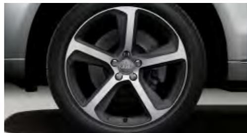
Aluminium-Gussräder im 5-Arm-Design anthrazit, teilpoliert, Größe 8,5 J x 20 mit Reifen 255/45 R 20*, inklusive Radlaufleisten
