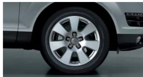
Winter-Aluminium-Schmiederäder im 7-Arm-Design Größe 7,5 J x 18 mit Reifen 235/60 R 18, schneekettentauglich, zulässige Höchstgeschwindigkeit 210 km/h
