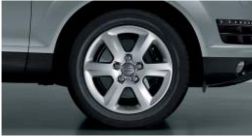
Aluminium-Gussräder im 6-Arm-Design Größe 8 J x 18 mit Reifen 255/55 R 18
