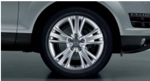
Aluminium-Gussräder im 5-Arm-V-Design Größe 8,5 J x 19 mit Reifen 265/50 R 19
