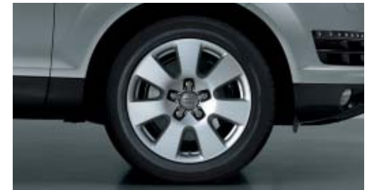
Winter-Aluminium-Schmiederäder im 7-Arm-Design Größe 7,5 J x 18 mit Reifen 235/60 R 18, schneekettentauglich, zulässige Höchstgeschwindigkeit 210 km/h
