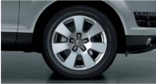
Aluminium-Schmiederäder im 7-Arm-Design Größe 7,5 J x 18 mit Reifen 235/60 R 18
